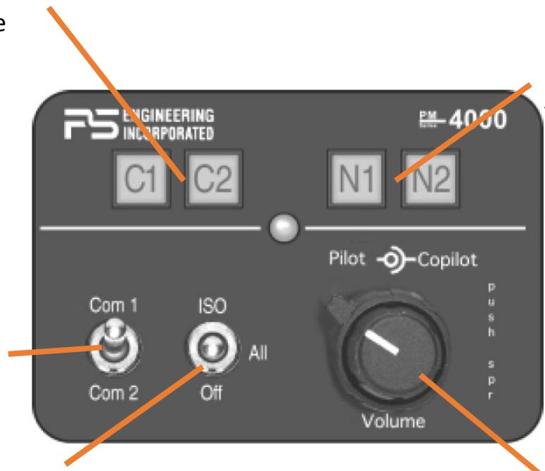
Boutons poussoirs NAV1 et NAV2 pour sélectionner la ou les radionav(s) en écoute. Eclairé si sur ON. Sur le F-HKRI, un seul VOR donc utiliser uniquement N1 (NAV1).
