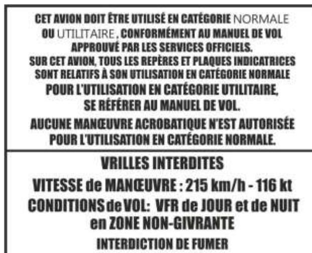
Figure 2-17 - Sur le plafond de la verrière mobile
