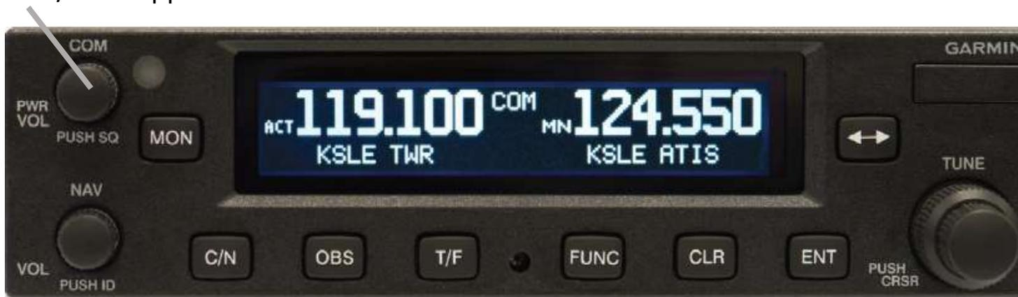
Le squelch est automatique mais peut-être désactivé en appuyant sur le bouton et réactivé en ré-appuyant sur le bouton.
