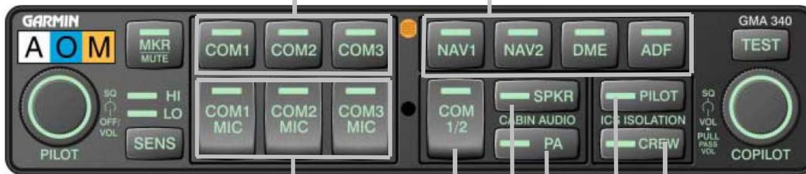
Sélection Radio COM sur laquelle se fait l'émission **Sur F-RO uniquement COM1-MIC est utilisé (GNC255).** Lorsqu'en émission le voyant de COMx-MIC clignote.
